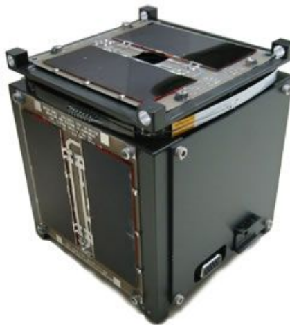
Figura 01: CP-1, o primeiro nanosatélite da Universidade Politécnica da Califórnia (Cal Poly). 1
